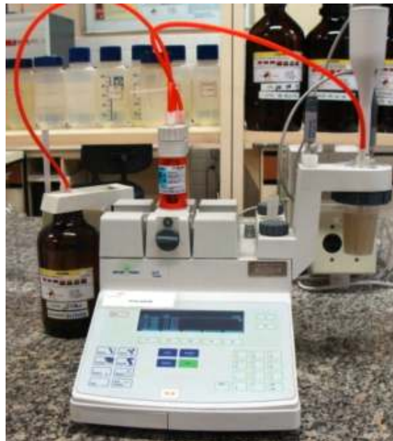
Figura 4. Medição da alcalinidade livre
