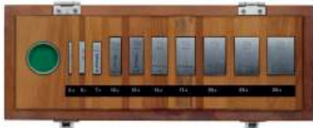
Fig. 12. Jogo de blocos-padrão para calibração de micrômetro externo Fonte: Mitutoyo (www.mitutoyo.com.br)
